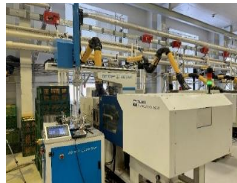
Автоматический комплекс по установке оси в крыльчатку
