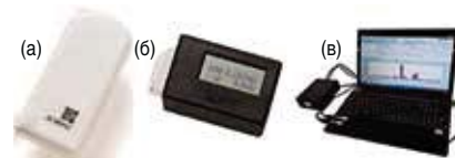
Рис. 1 Дозиметры D-Shuttle и их периферическое оборудование: (а) дозиметр D-Shuttle; (б) переносной индикатор (handy indicator); (в) рабочая станция (dedicated workstation)
